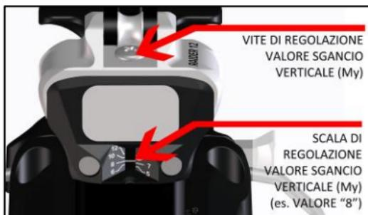
**Per aumentare il valore di sgancio impostato è necessario avvitare la vite in senso orario.**
